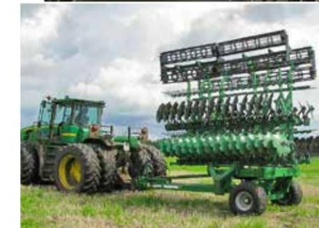
Kompakte Abmessungen im Transportzustand
