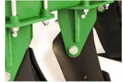
**Steinsicherung mittels Abscherbolzen**
