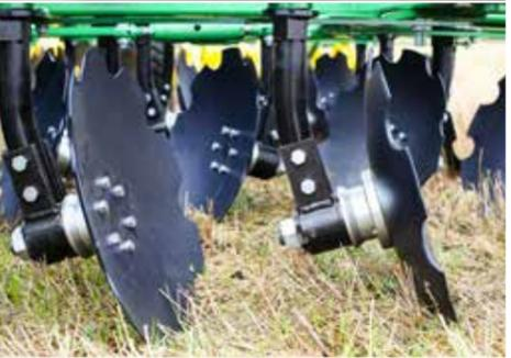
**Die Lagereinheiten sind aufgebaut im passiven Bereich der Scheiben**
