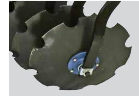
Die wartungsfreien Lagereinheiten aufgebaut im passiven Bereich der Scheiben
