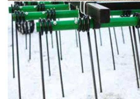
**Kaltgeformte stahlgiesgestrahlte Federzinken**
